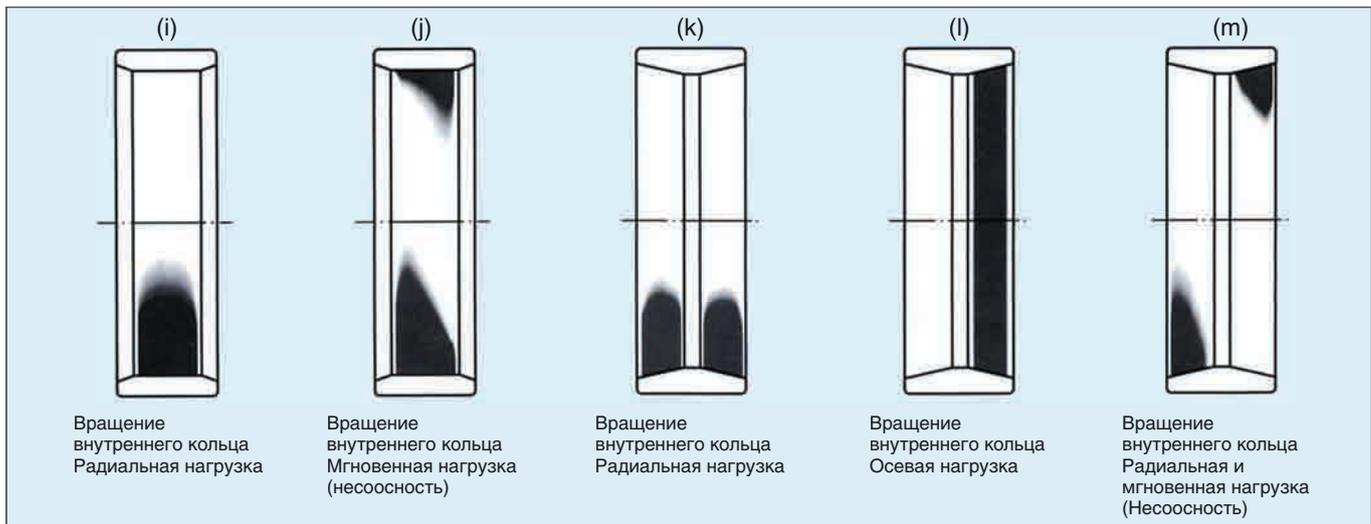
Рис. 6.2 Типичные дорожки качения на роликовых подшипниках
