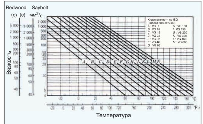
**Рис. 4.1** Зависимость между вязкостью масла и температурой
